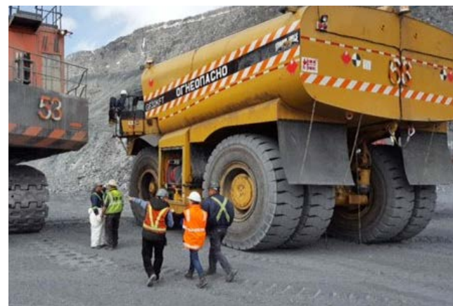
Обогреваемый топливозаправщик для экстремальных условий
