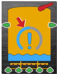
La notificación alertará al operador del tiempo que resta hasta que el estanque quede vacío y la bomba del agua se cierre. Cuando el nivel de agua alcance el punto de cierre por bajo nivel, la bomba se cerrará automáticamente para evitar que ésta se dañe. Una vez cerrada, el ícono de la bomba de agua aparecerá en rojo en la pantalla principal.
