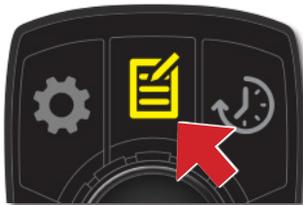
Después de presionar el botón 2, el operador podrá elegir cuál de las válvulas aspersoras de agua agregará al programa, dependiendo de la configuración específica de ese camión cisterna. Gire el botón del centro para visualizar las válvulas disponibles, moviendo de izquierda a derecha y de arriba a abajo. La válvula actual aparecerá indicada por un cuadrado amarillo.
