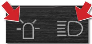
3. Teclado: Presione el botón que indica LUCES DE OPERACIÓN o BALIZA DE SEGURIDAD.
