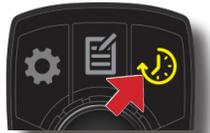
El botón cambiará a amarillo en el panel y aparecerá un dial. Si selecciona el modo escalonado, el dial cambiará a amarillo. Gire el botón del centro para ajustar los intervalos on y off, en el caso del modo escalonado. Una vez finalizado, vuelva a presionar el Control de Temporizador para salir del menú Configuraciones del temporizador.
