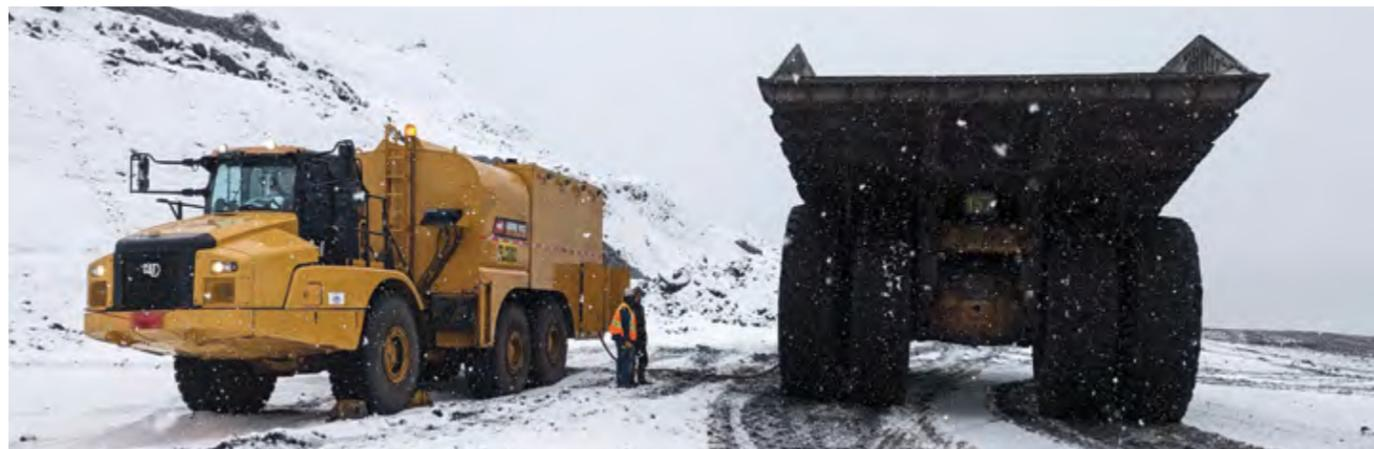
Les caisses carburants et lubrifiants articulées Ground Force sont conçues sur mesure avec des spécifications adaptées à votre opération individuelle et sont fabriquées pour résister aux conditions/applications extrêmes et dures.
