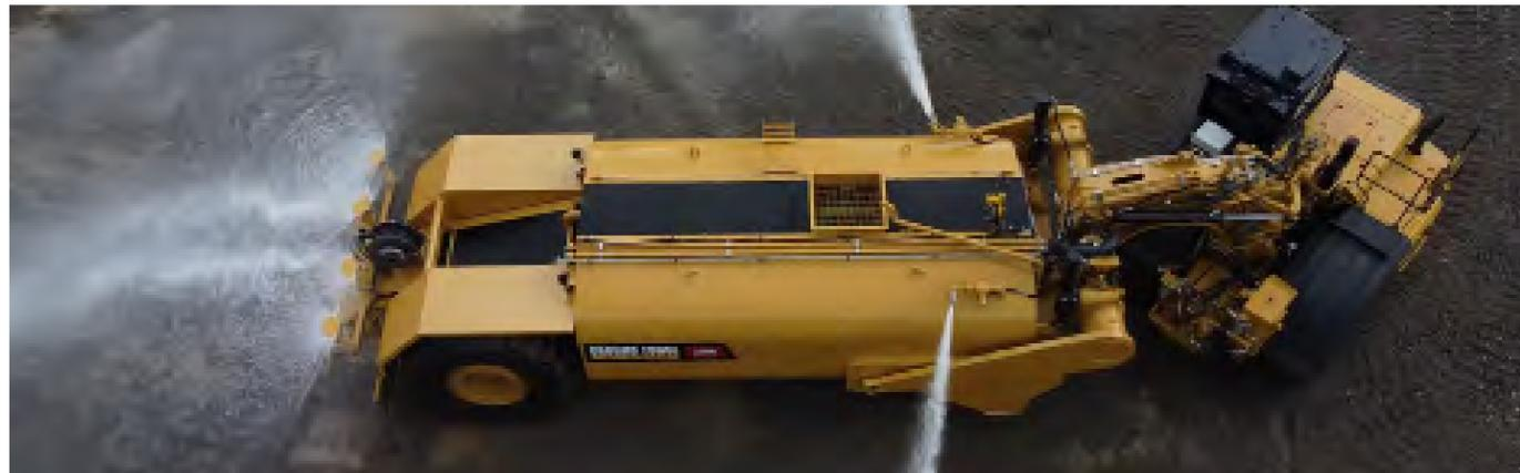
Les tracteurs à eau Ground Force sont conçus pour être prêts à l'emploi et faciles à utiliser. Conçus pour les applications de construction lourde et d'exploitation minière, ils répondront à tous vos besoins de suppression de poussière, de lutte contre les incendies et d'exigence générales de camions-citernes.
