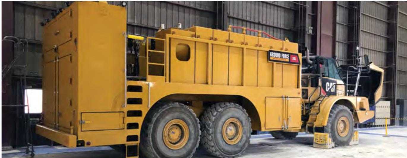
Les caisses Ground Force lubrifiant seul offrent des capacités de lubrification maximales quand votre opération est importante et que vous avez besoin d'une livraison efficace de fluides. Ces caisses sont conçues pour s'adapter aux châssis rigides, articulés et conventionnels pour offrir la gamme de flotte la plus diversifiée.
