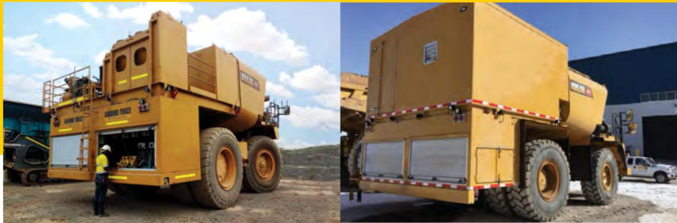
Camions-Citernes Carburants / Lubrifiants Avec Châssis Rigide
