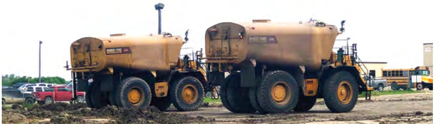
Los camiones cisterna de bastidor rígido de Ground Force están diseñados para asegurar que su camión cisterna entregue la cantidad de agua que usted necesite, de manera eficiente y segura. Además de solucionar todos sus problemas de supresión del polvo, combate el fuego y necesidades encargadas a camiones cisterna en general. Estas cajas, están diseñadas para transportar grandes volúmenes de agua para manejar las mayores operaciones.
