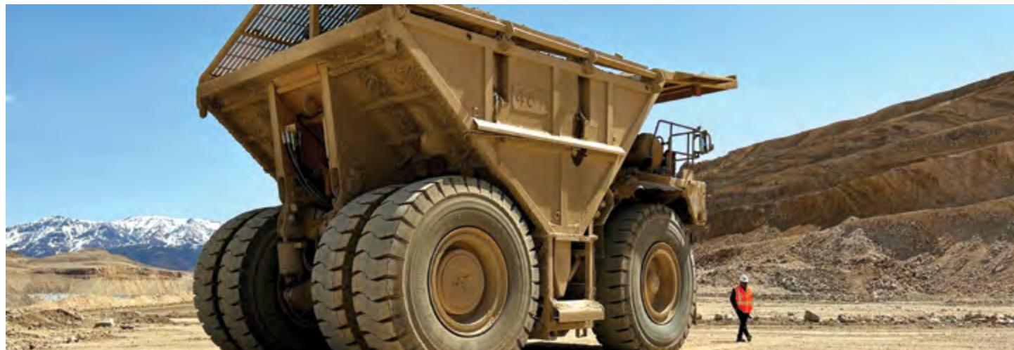
El diseño de las cajas esparcidoras de gravilla de Ground Force está pensado para cumplir con las demandas de su programa de mantenimiento de caminos de transporte, ofrecer menores costos de operación y mayor eficiencia. Estas cajas reemplazan diversos equipos, reducen el número de operadores y ofrecen máximo desempeño en la gran mayoría de los caminos más desafiantes.
