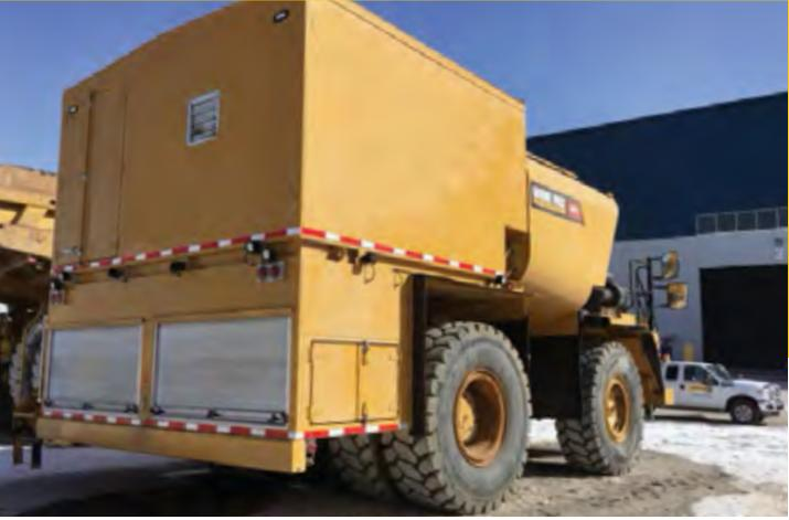
Camiones de bastidor rígido para combustibles y lubricantes
